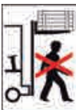
Nicht unter angehobene Lasten treten
