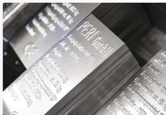
Stahlblech erhaben geprägt
