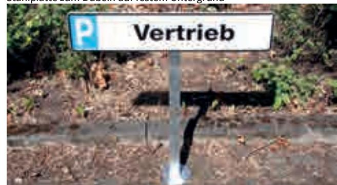
Pfosten mit geschweißter Bodenplatte, 80 x 80 mm (4 Löcherungen a 10mm), aus T-Profil 25 x 25 x 3 mm, galvanisch verzinkt, komplett vorgebohrt einschließlich Alu-Platte mit Befestigungsmaterial, zum Anbringen eines KFZ-Kennzeichens 520 x 110 mm
