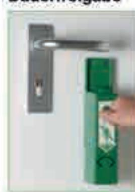
Mit dem Geräteschlüssel kann der Türwächter durch Verschieben nach unten alarmfrei in eine Dauerfreigabeposition gebracht werden. In dieser Stellung ist die Tür normal zu begehen. Ein Daueroffenkontakt ist auf Wunsch möglich.
